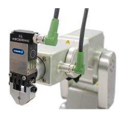
(d) The gripper completely installed
